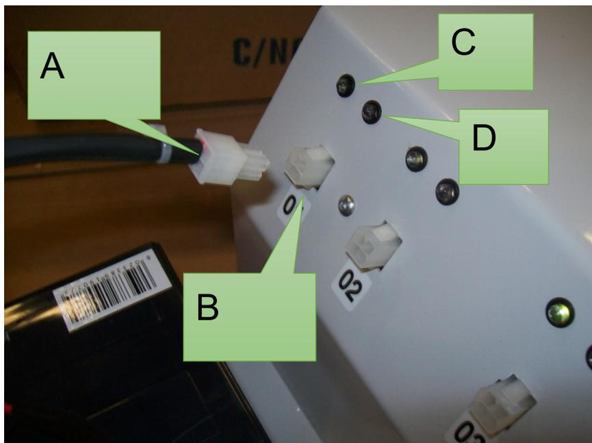
La surface où charger les 10 batteries est indiquée dans la photo ci bas. On fait remarquer que le câble standard directement branché sur les batteries est assez long pour arriver aux connecteurs sur le chargeur de batterie, indépendamment du fait que la batterie soit plus ou moins près du connecteur. En fait, les batteries devront être placées sur deux rangées.
